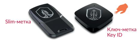
О необходимости замены элемента питания свидетельствуют 5 коротких звуковых сигналов после опознавания радиометки (для Призрак-8L и Призрак-8L/Smart после включения зажигания). В Ключ-метке Key ID используется элёмент питания типа CR 2032, а в Slim-метке — CR 2025. Для его замены обратитесь по месту установки сигнализации или произведите замену самостоятельно.
